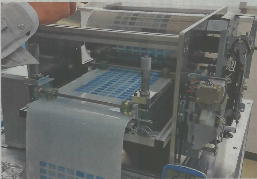
フィルム製剤を効率よく製造するために開発したロータリー式の印刷装置＝富山大提供
